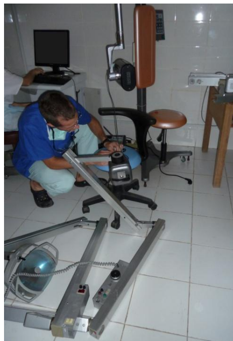
Figure 3 Reparieren der Röntgenapparatur
